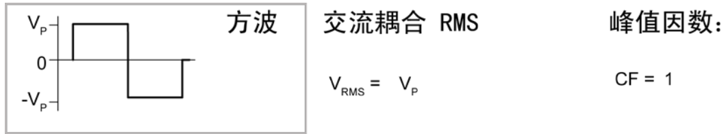
图 33: RMS 计算值和峰值因数 — 方波整流
