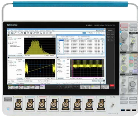
在 5 系列 B MSO 上运行的 SignalVu-PC 上的脉冲分析
